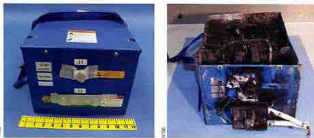
La batterie lithium-ion du 787, avant et après l'incendie sur un appareil de la JAL.
